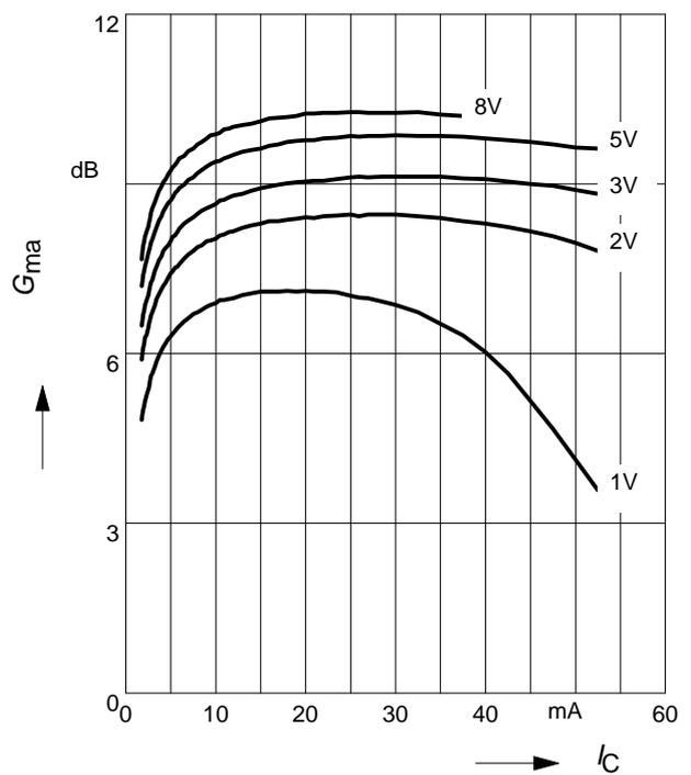
**Power Gain**  $G_{ma}, G_{ms} = f(V_{CE})$ :
